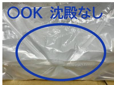
リバースコート専用混合液は袋の底に糊成分が沈殿していますので、**袋を手でよく揉み込んで混ぜ合わせてください**。(写真参照)
