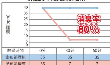
※リバースワックス塗布済フローリングでの試験
