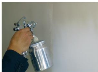
エアコンプレッサーで吹き付けるスプレーガンを用意します。上の写真は塗料用でキャップを外すタイプです。
