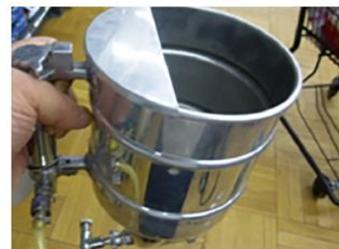
上部から注ぎ足すタイプ。作業性が良くメンテナンスも容易なため、吹き付けにはこのタイプが最適です。
