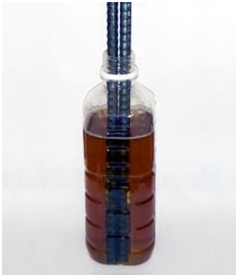
住宅基礎用鉄筋をリバーズ溶液に 1時間浸した後に取り出して 乾燥
