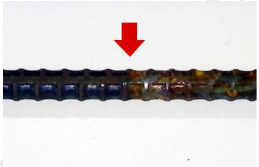
乾燥後 24 時間経過 矢印より左部分はリバーズ溶液の効果で赤さびが取れました
